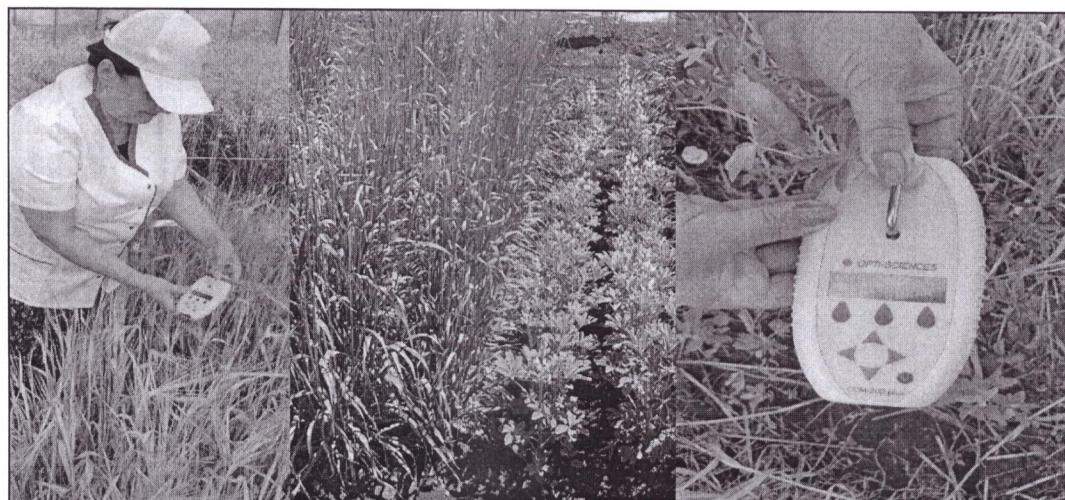
**Determinarea indicelui de concentrație a clorofilei (CCL) cu ajutorul contorului OPTI SCIENCES CCM 200.**
